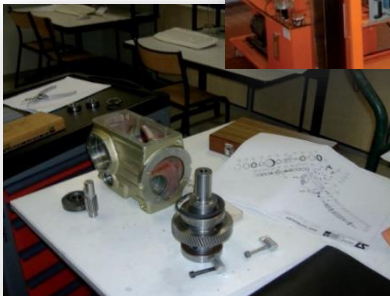
REDUCTEUR EN COURS DE DEMONTAGE
